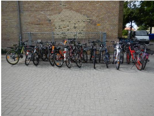
Ausgelastete Anlage vor der Grundschule Finow mit ungeeigneten Felgenklemmern
