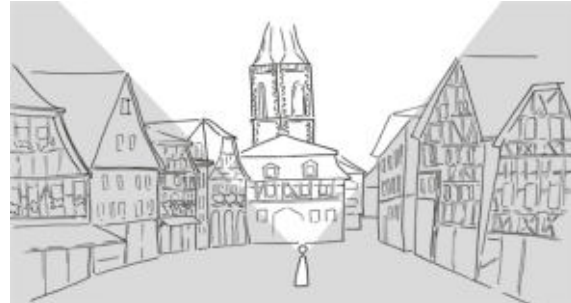
Abbildung 46 Schematische Darstellung des SkyView Faktors
